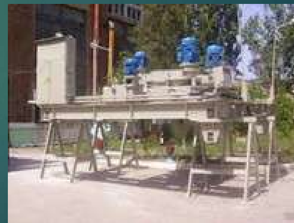
Машина камнерезная для добычи на открытых разработках стеновых камней
